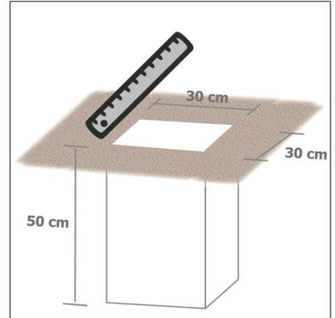
❹ Das Loch 10 cm mit Kies auffüllen. Dadurch kann Regenwasser besser abfließen.
