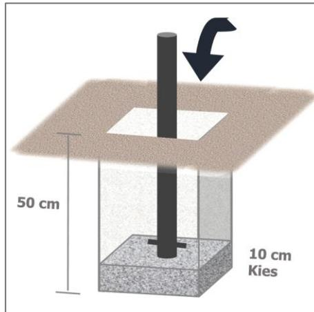
❻ Das Loch mit Zement auffüllen und Pfosten ausrichten.
