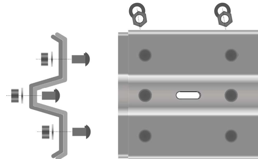
! 1 x Artikel 35697 reicht für 1 Befestigungspunkt. Also z. B. zur Verbindung von 1 Plankenholm mit 1 Endstück.
