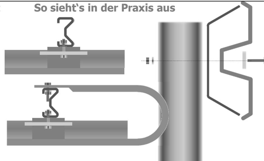
! 1 x Artikel 35698 reicht für 6 Befestigungspunkte. Also z. B. bei einer 1-holmigen Leitplankenstrecke für die Befestigung der Plankenholme an 6 Pfosten.
