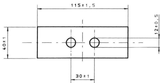
Decklaschendicke  $5\text{mm} \pm 0,5\text{mm}$
