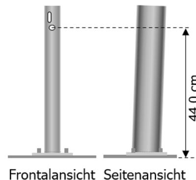
Gemäß TL SP müssen SIGMA-100-Pfosten auf Bauwerk eine um 4 % nach hinten ausgerichtete normative Querneigung vorweisen und hintere Muttern aus PA 66 als Sollbruchstelle besitzen.
