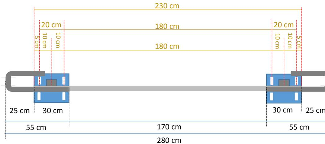
**Hinweis:** Es empfiehlt sich erst der Aufbau und anschließende Bodenmontage, da die Leitplankenverschraubung an den Pfosten und die Pfostenbefestigung im Boden mit Spiel versehen sind.
