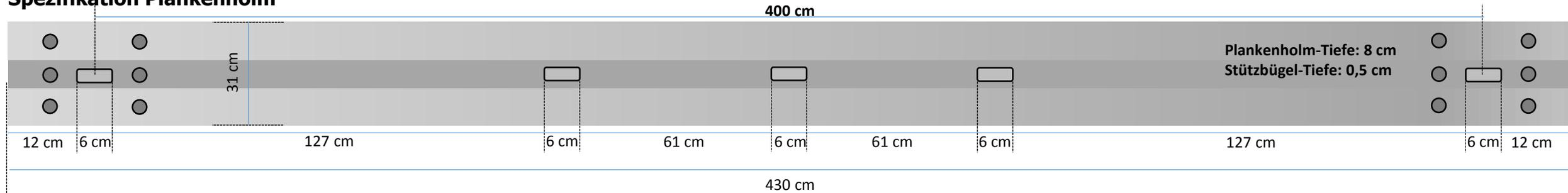
**Hinweis:** Es empfiehlt sich erst der Aufbau und anschließende Bodenmontage, da die Leitplankenverschraubung an den Pfosten und die Pfostenbefestigung im Boden mit Spiel versehen sind.
