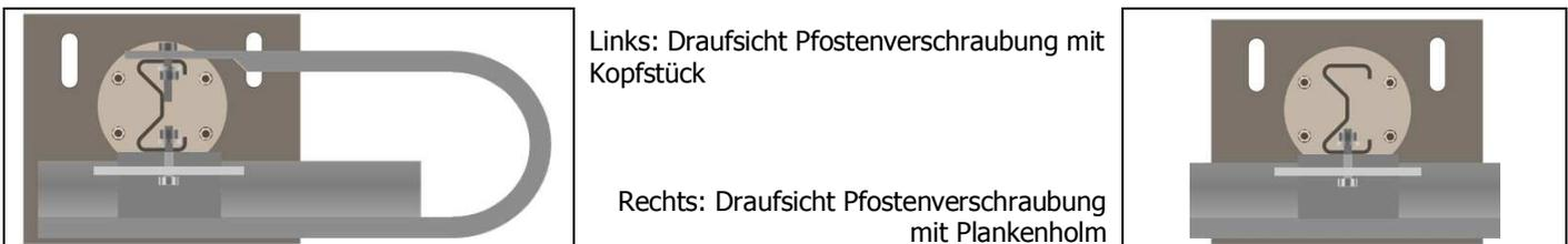
Verschraubung der Pfosten im Boden:
