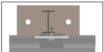
Rechts: Draufsicht Pfostenverschraubung mit Plankenholm
