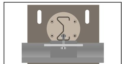
Rechts: Draufsicht Pfostenverschraubung mit Plankenholm
