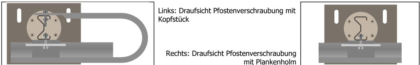
Verschraubung der Pfosten im Boden:
