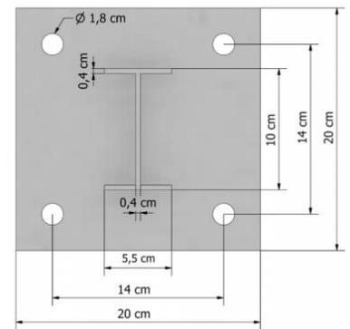
Bodenplatte; Materialstärke 1,2 cm
